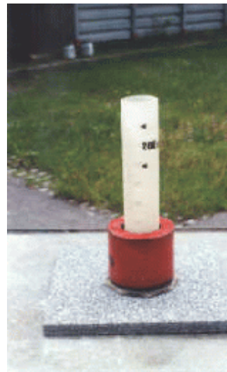
Abbildung1 Rauheitsbestimmung durch Ausflußmessung nach D.F. Moore
