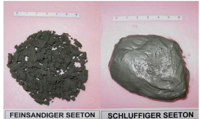
Bild 2: Vergleich zwischen feinsandigem und schluffigem Seeton; exemplarische Darstellung
