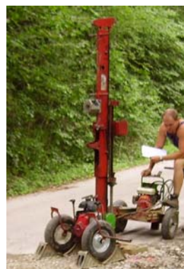
Bild 6: Rammsondierung zur Feststellung des Verdichtungserfolges; Einsatz im Bereich einer Kanalkünette; Sondiergerät (links) und Messergebnisse (Schlagzahldiagramm, rechts)
