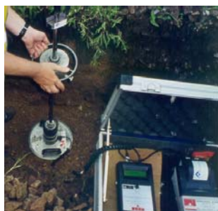
Bild 4: Dynamischer Plattendruckversuch; Einsatz im Rahmen einer Baugrunderkundung (links) und schematische Darstellung der Versuchseinrichtung (rechts)
