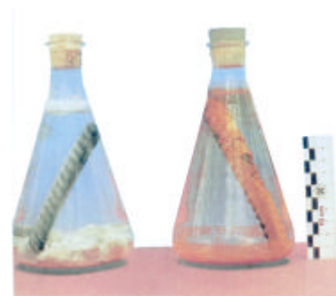
Betonstahl in alkalischer Lösung Wasser
