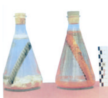
Betonstahl in alkalischer Lösung Wasser
