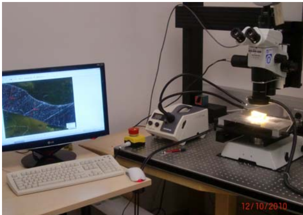
Abbildung 2: Stereo Messmikroskop mit Bildbearbeitung
