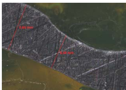
Abbildung 5: Mikroskopische Vermessung der Stahlblechdicken und Dokumentation der oberflächigen Lackbeschichtung bzw. Verzinkung.
