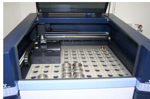
Abbildung 2: Probenkammer mit 56 Stellplätzen
