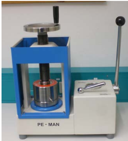
Abbildung 3: Hydraulische Presse für die Präparation von Presstabletten
