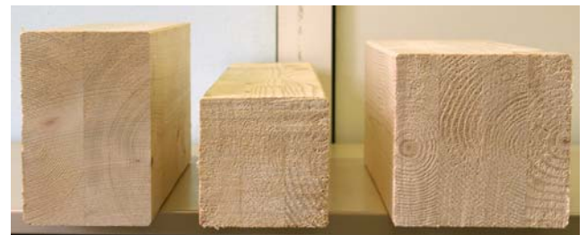
Bild 3: Versuchskörper mehrfach verleimt
