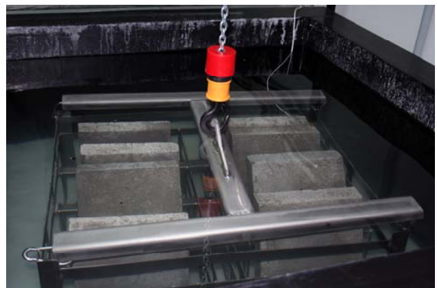
Bild 2: Untergrundbetonplatten im Probenkorb
