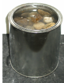
Bilder 7 und 8: Frostprüfung an Gesteinskörnungen
