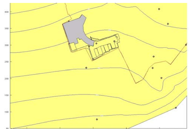
Bild 3: Grundwasserstrom im Urzustand, Darstellung als Grundwasserisohypsenplan
