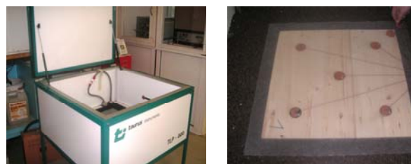
Bild 6: Messtechnische Ermittlung der Wärmeleitfähigkeit im Zweiplattengerät
