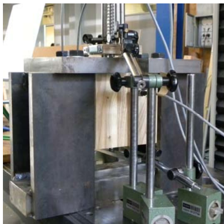
Bild 2: Prüfvorrichtung für d = 20 mm, Verformungsmessung mittels sechs induktiver Wegaufnehmer W10TK der Fa. HBM
