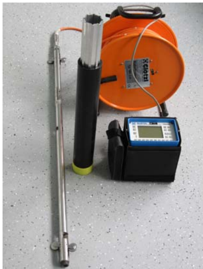
Bild 1: Neigungsmesseinrichtung; Messsonde, Führungsrohr (Teilstück), Messleitung, und Anzeigegerät.
