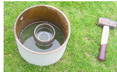
Bild 5: Probennahmestelle; Detailsprache und Schichtstärkenermittlung (oben) Untersuchung der Versickerungsleistung (unten)
