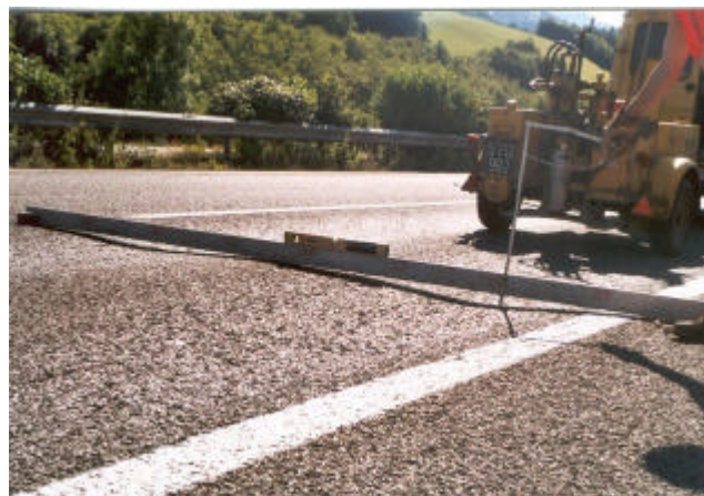
A 9 Treglwang (Spurrinntiefe bis zu 45mm)
