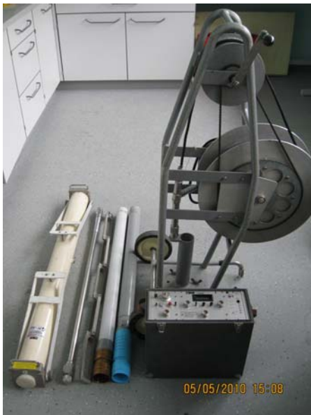
Bild 1: Gleitmikrometer: Kalibrierrohr aus Invar-Stahl, Gleitmikrometersonde mit Führungskette, 2 unterschiedlichen Typen Führungsrohr, Kabeltrommel, und Anzeigergerät.
