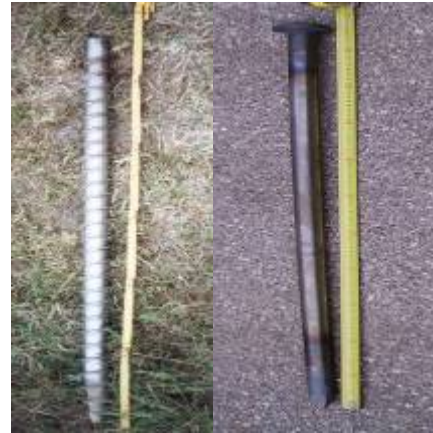
Bild 2: Unterschiedliche Nagelsysteme: Alpinanker (links) und Erdnagel (rechts)
