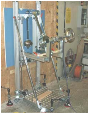
Abbildung 3: Prüfaufbau vertikale Kraftabbaumessung MPA Stuttgart
