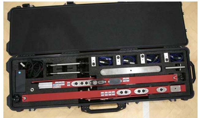
Abbildung 4: Messrechnersystem für Standardverformung, Durchbiegungsmulde und Kraftabbau
