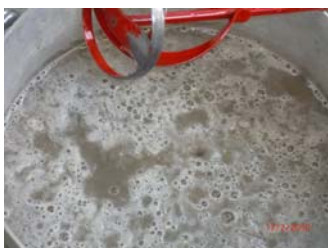
Bild 4: Prüfung der aufschwimmenden Fasern aus Polypropylen (PP)
