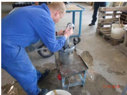
Bild 3: Prüfung des Luftporengehaltes mit dem Luftporentopf
