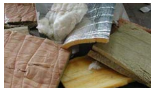
Dämmstoffe, Rohrverkleidungen (KMF)
