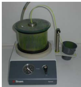
Bild 2: Probe wird unter Vakuum in gefärbtem Kunstharz eingebettet
