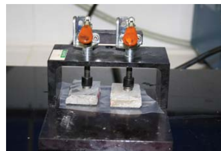
Bild 5: Aufkleben der Proben auf den Objektträger
