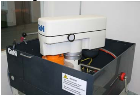
Bild 7: Schleifen des Dünnschliffes auf 0,03 mm
