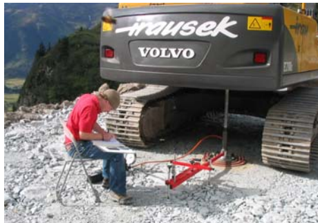
Bild 3: Lastplattenversuch DN 760 mm
