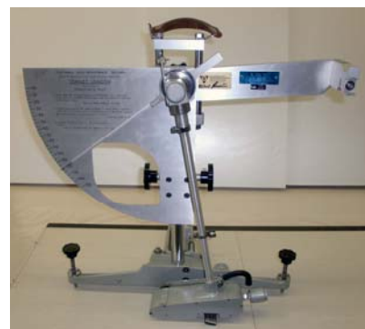
Bild 3: SRT-Pendelgerät gemäß DIN EN 1341
