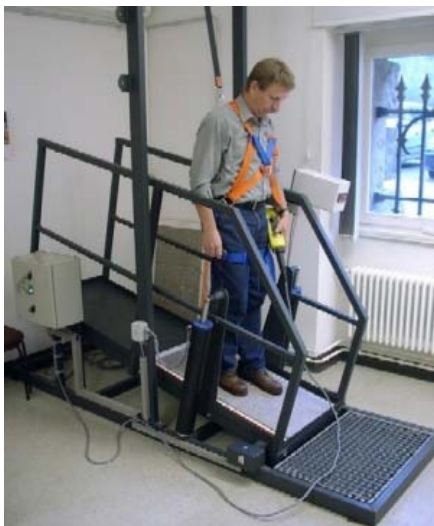
Bild 1: Schema einer Laborprüfung auf der „schiefen Ebene“
