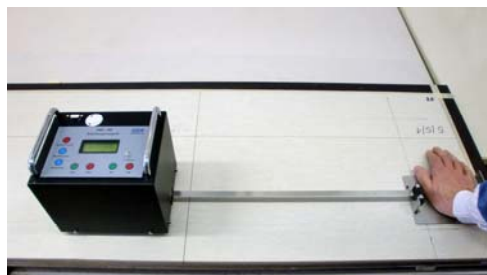
Bild 4: Messung des Gleitreibungskoeffizienten \mu mit GMG 200
