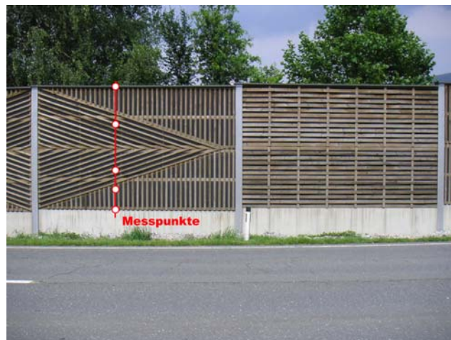
Bild 1: Anordnung der Messpunkte am untersuchten System
