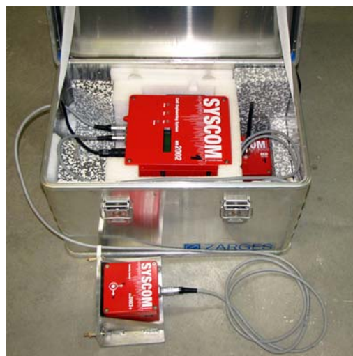
Bild 2: Messgerät für Langzeitüberwachung mit automatischer Alarmierung
