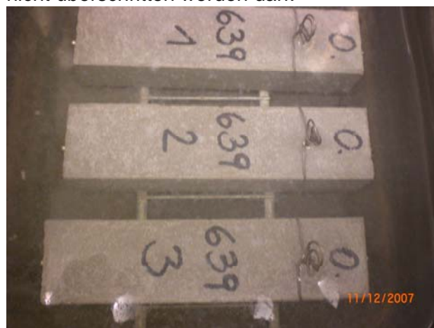
Bild 3: Prismenlagerung in einer NaOH-Lösung mit einer Temperatur von 80°C.
